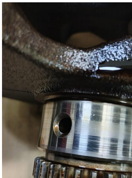
Gambar 4. kerusakan pada seal input shaft yang menyebabkan keluarnya aliran oli dari celah area input shaft transmisi
