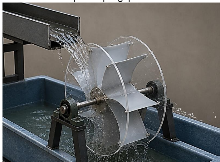
Gambar 3. Instalasi Pengujian Kincir Air Overshot
