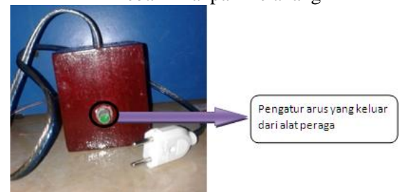
Gambar 3. Alat Peraga Pengatur Arus Beban Tampak Depan
