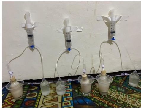
Gambar 1. Spirometer Syringe Sederhana Untuk Mengukur Volume CO 2 Hasil Fermentasi Alkohol
