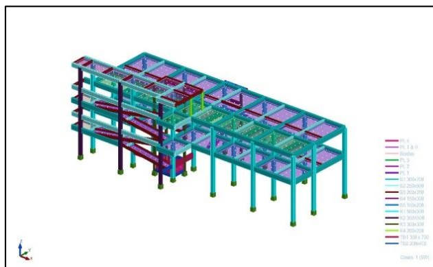
Gambar 1. Pemodelan Gedung Rawat Inap Rumah Sakit Condong Catur dengan Autodesk RSAP
